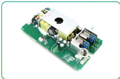
300W ACDC内置电源模块 (特种设备)
